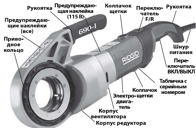
Рис. 2 – Силовой привод модели 690-I
