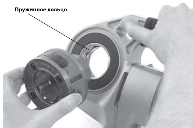
Рис. 9 – Установка резьбонарезных головок в силовой привод 600-I
