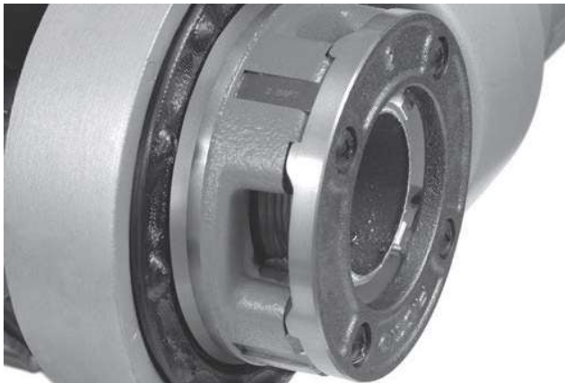
Рис. 15 – Торец трубы вровень с кромкой резьбонарезных гребенок
