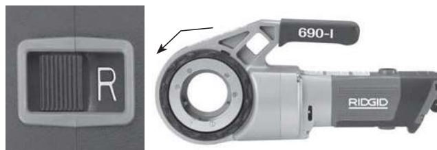
Рис. 6В – Переключатель в положении R (НАЗАД) (против часовой стрелки)
