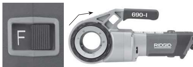
Рис. 6А – Переключатель в положении F (ВПЕРЕД) (по часовой стрелке)
