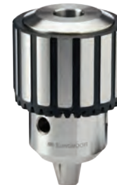
Сверлильный патрон Ø 1,5—16 мм, под конус B16 IBK.16
