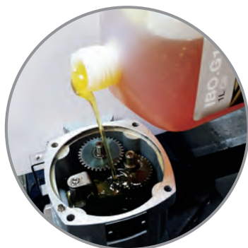
Редуктор с масляной ванной
