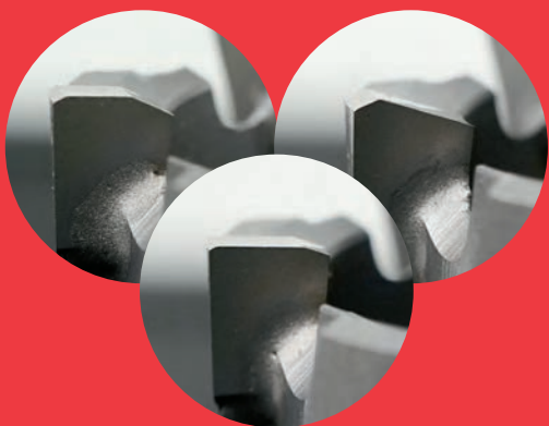
Фрезы TCT имеют 3 вида зубьев с разными углами заточки (подрезной/промежуточный/зачищающий)
