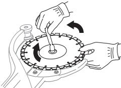
**ЗАМЕЧАНИЕ!** Диски должны вращаться при затянутой гайке. Это будет свидетельствовать о том, что ремень не зажат на дисках между объединенными половинками приводного ремня, когда диски и приводной ремень стягиваются с помощью гайки. Лучше это делать поочередно, то есть слегка затянуть, немножко провернуть и так повторять, пока диски не будут закреплены.
