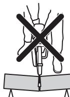
Если диск зажат или застрял в зоне отдачи, сила реакции будет толкать устройство вверх и назад к оператору вращательным движением, что может вызвать опасную или даже смертельную травму. Следите за возможными перемещениями распиливаемого элемента. Если распиливаемая деталь неправильно закреплена и смещается при резке, может произойти заклинивание режущего диска и возникнуть отдача.
