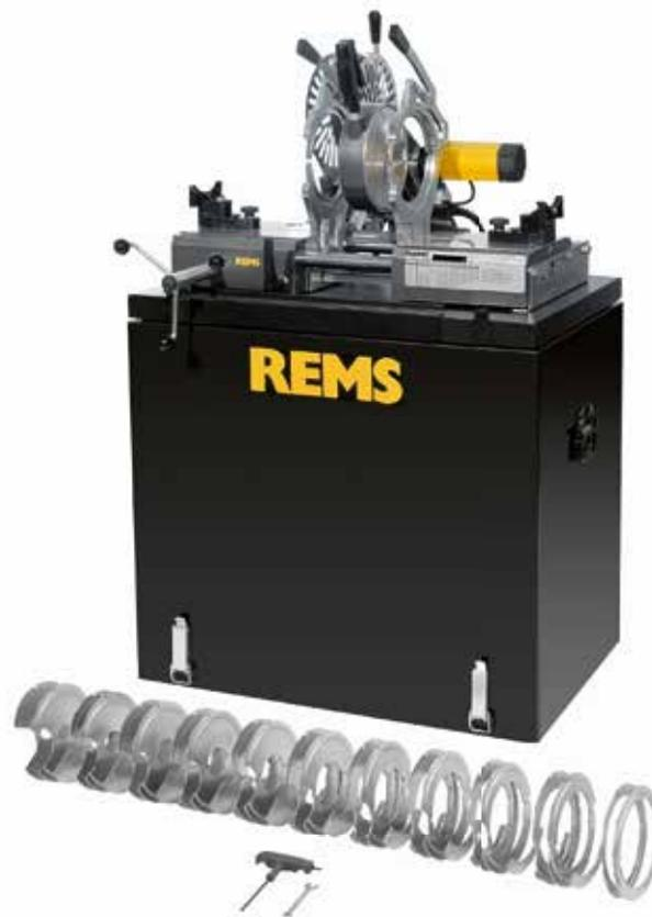
Удобная, переносная компактная машина. Идеальна для монтажа сантехники, переноса сточных труб, реконструкции камина трубами PVDF. Для стройплощадки и цеха.
