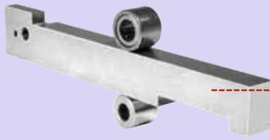
Стабильный, прямоугольный ходовой маятник Из прочной, специальной стали, по направлению нагрузки точно посажен на игольчатые подшипники, которые направляют маятник с обеих сторон по всей длине хода, для ровного прямоугольного без сколов реза даже при жесткой эксплуатации с многократно усиленным давлением на пильное полотно, например, при использовании бугеля. Для сверхдолгого срока службы.
