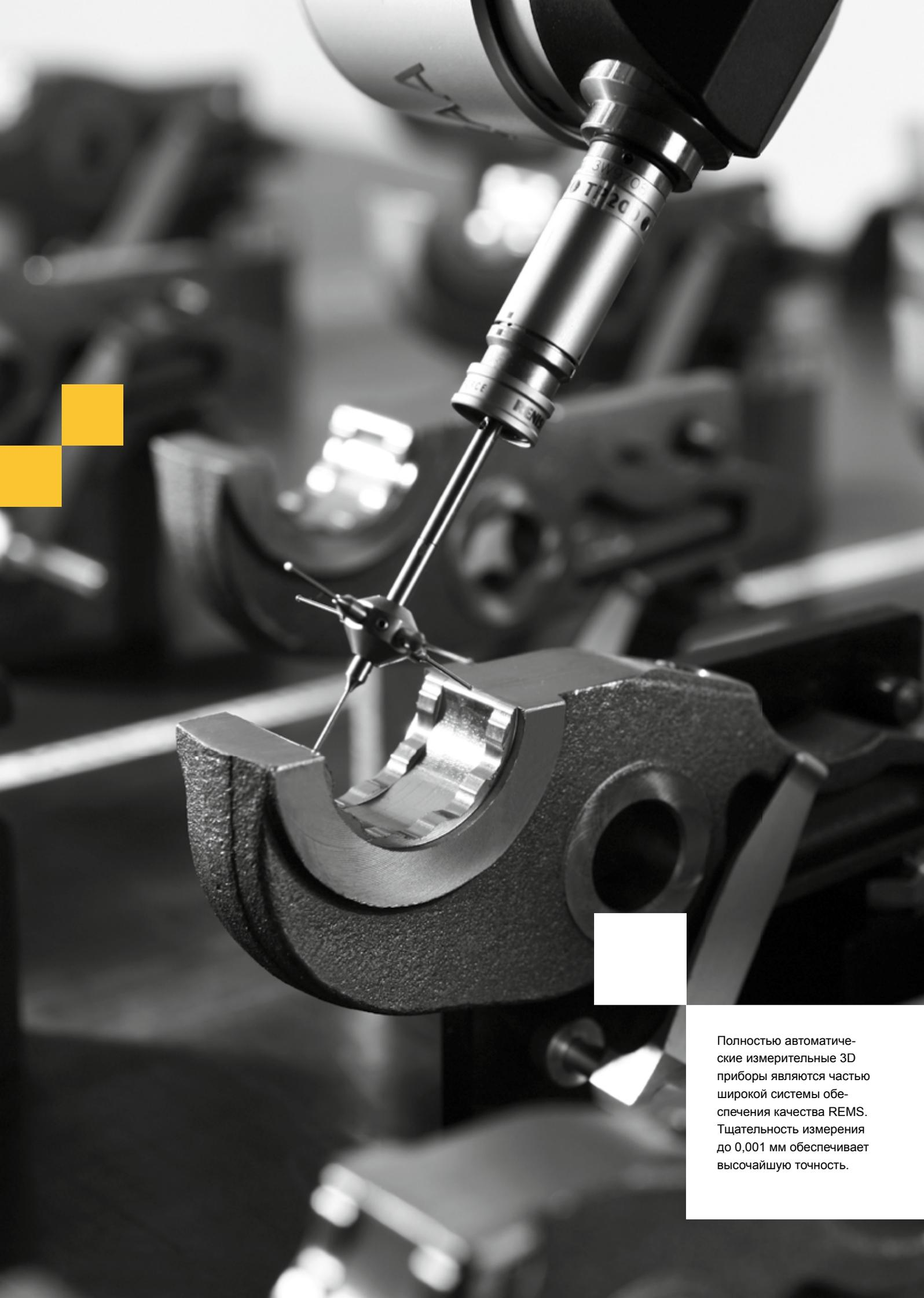
Полностью автоматические измерительные 3D приборы являются частью широкой системы обеспечения качества REMS. Тщательность измерения до 0,001 мм обеспечивает высочайшую точность.
