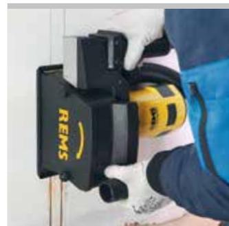
Полностью прилегающая пластина во время всего процесса шлицевания/отрезания для управляемого погружения алмазных отрезных кругов, надежной работы без образования пыли и легкой.
