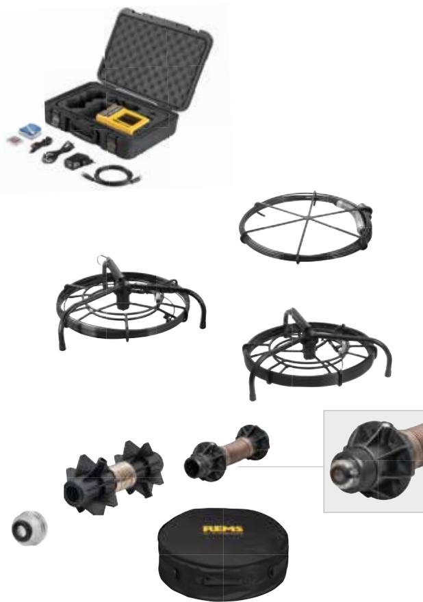
Сверхлегкая, удобная электронная инспекционная система с камерой для экономичной инспекции и анализа ущерба в трубах, каналах, дымоходах и других полостях. Камера с самонивелированием. Передатчик с обнаружением головок камеры. Электронный счетчик метража. Также для инспектирования после работ по очистке труб и приемки нового оборудования и оборудования после ремонта. Документирование снимков и видеоизображений с записью речи на карте SD. Работа от аккумулятора или от сети.
